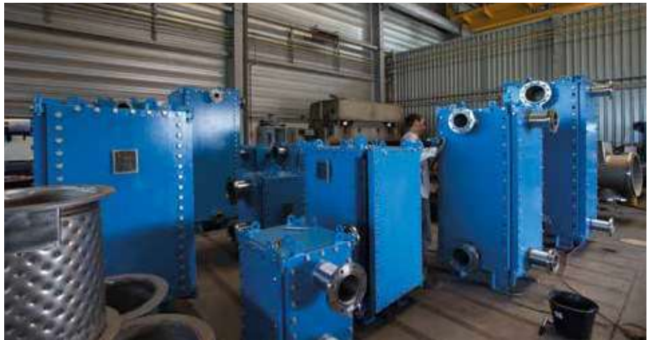
Ziemex conçoit des échangeurs Zieblock à très forte capacité, qui permettent un nettoyage de la totalité de la surface d'échange, sur les deux circuits.
