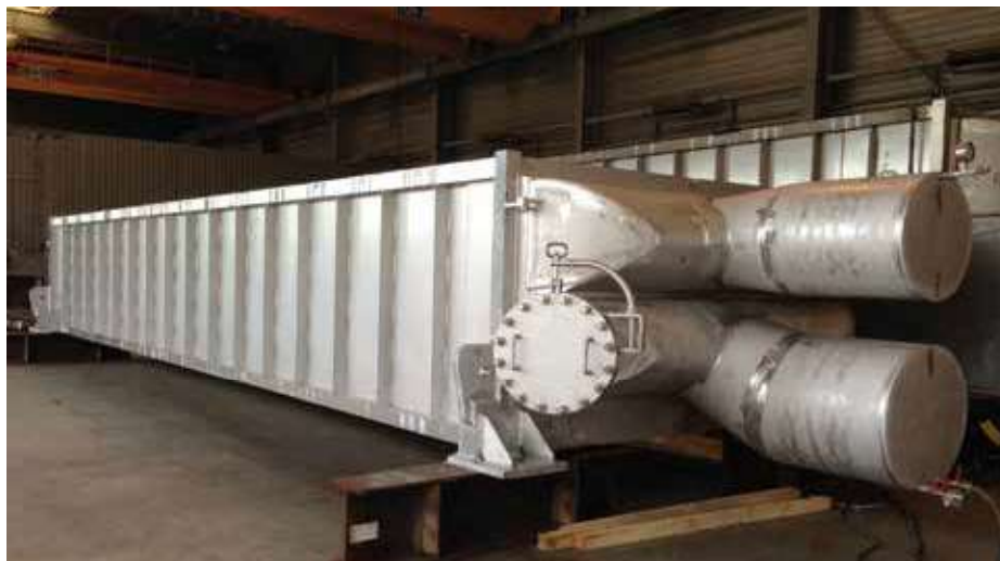
Ziemex réalise la fabrication d'échangeurs à plaque de type tube-tube, soudés au laser, via Ziepack, sa filiale commune avec Alfa Laval-Packinox.
