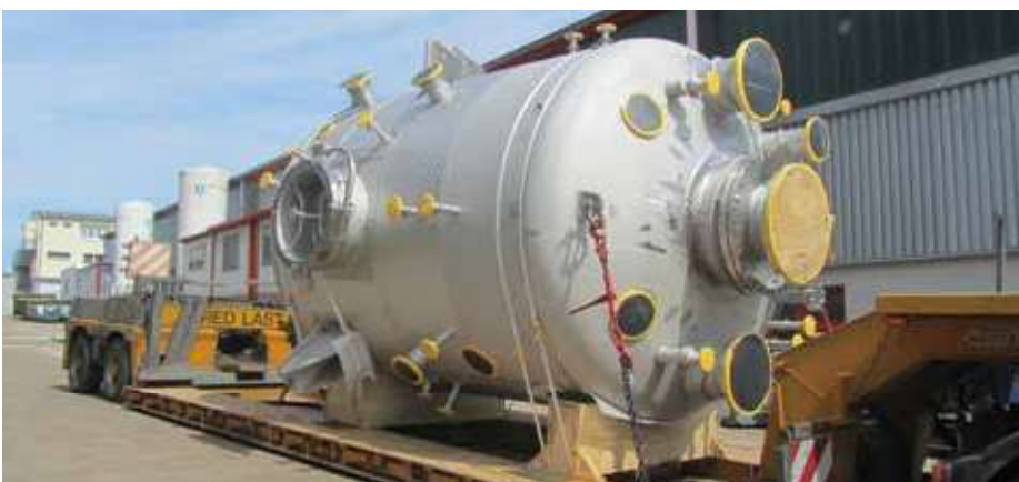
Ziemex transporte ses équipements à travers le monde en une pièce jusqu'à 6,8 mètres de diamètre et 80 tonnes. Au-delà, les solutions sont construites sur site.
