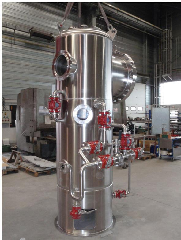
**Nettoyage facile:** L'absence de zone morte combinée à une conception totalement vidangeable, une faible rétention de liquide, et des surfaces lisses permettent un nettoyage parfaitement efficace compatible avec les exigences de la FDA. THERMIPACK® est équipé de buses pour un nettoyage fiable sans aucun démontage.
