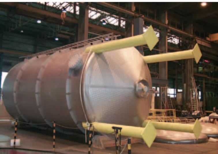
Nous fabriquons des cuves de toutes dimensions et de grande qualité pour les processus de production de l'industrie du papier. Avec notre technique de double enveloppe matelassée soudée par laser, ces cuves sont refroidies ou réchauffées selon les besoins spécifiques de chaque client. Pour des cuves à liqueur noire, nous travaillons l'acier DUPLEX. Notre expérience dans la construction chaudronnée avec différents matériaux est un atout pour nos clients.
